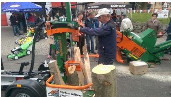
Holzspalter und Kippsägen werden heutzutage mit Schutzvorrichtungen betrieben
